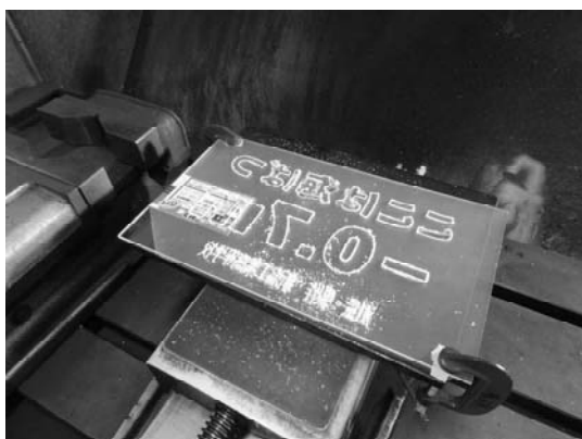
図7．MCによる文字加工
