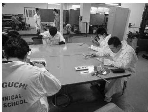
板金作業（銅板による表札の作成）
