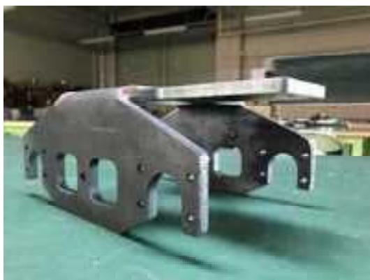
図5 レーザー加工後、曲げ加工をした車箱
